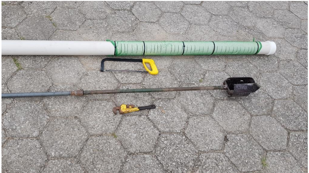
Figura 6 – PVC ranhurado e revestido de tela para filtragem de sedimentos usado na confecção do piezômetro.
